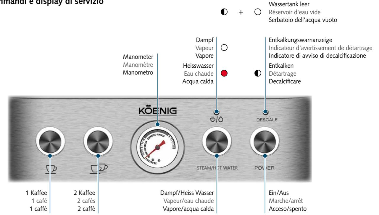
**i** Aus Hygienegründen spült die Maschine vor der Abschaltung die Dampfduse und Kaffeeausläufe mit heissem Wasser.
