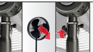
Ventilator ausrichten, fixieren
